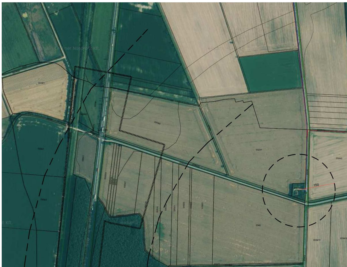
M86 gyorsforgalmi út „Egyházasrádóci csomópont” környezetének közműkeresztezései, illetve a meglévő szennyvíz-tisztító és 150 m-es védőtávolsága (ekozmu.hu, saját szerkesztés)
